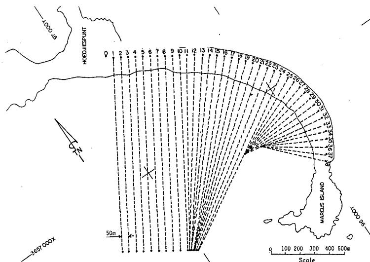
FIGURE 4 : POSITION OF THE SURVEY LINES
