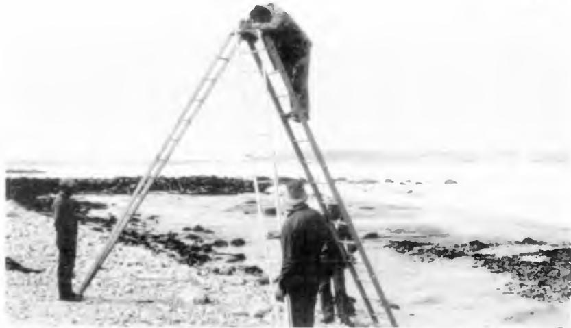
FIGURE 3 : TRIPOD USED FOR THE BEACH PHOTOGRAPHY
