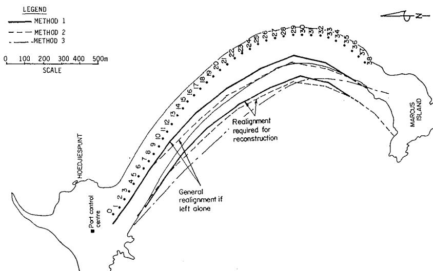
FIGURE 9 : OPTIMUM ALIGNMENT OF THE BREAKWATER
