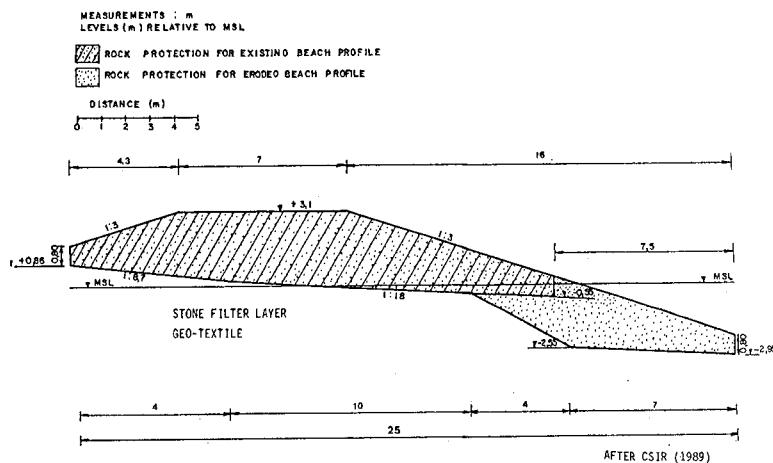
FIGURE 12 : CONCEPTUAL LAYOUT OF ROCK PROTECTION
