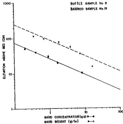
Fig. 11 TYPICAL CORRELATION BOTTLE SAMPLER / BAMBOO SAMPLER
