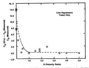
RELATIVE DIFFERENCE OF C<sub>D</sub> FOR AIRY WAVE THEORY AND MEASURED VALUES VERSUS THE VELOCITY RATIO
