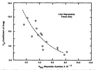
COEFFICIENT OF DRAG VERSUS REYNOLDS NUMBER FROM COMPUTATIONS USING STOKES THIRD ORDER WAVE THEORY FIGURE 12
