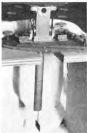
Photo 3. Drag-Plate Velocity Meter
