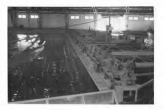
Fig. 3.1. The Plunger-Type Wave Generator
