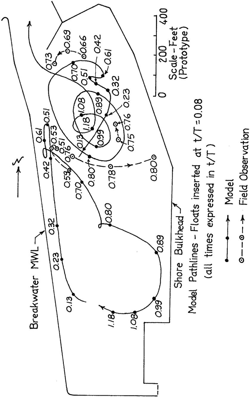
Fig. 6. Drogue Pathlines, Model-Prototype Comparison
