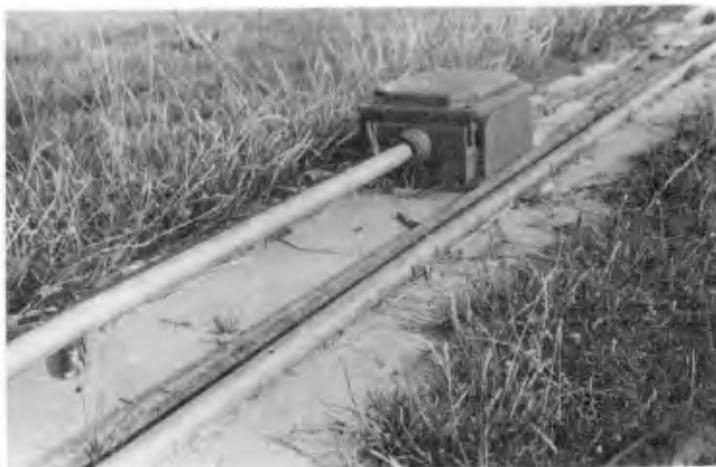
Fig. 5 THE STEEL BOX WITH THE TRANSCIVER
