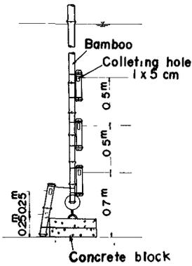
Fig. 7. Bamboo-sampler.
