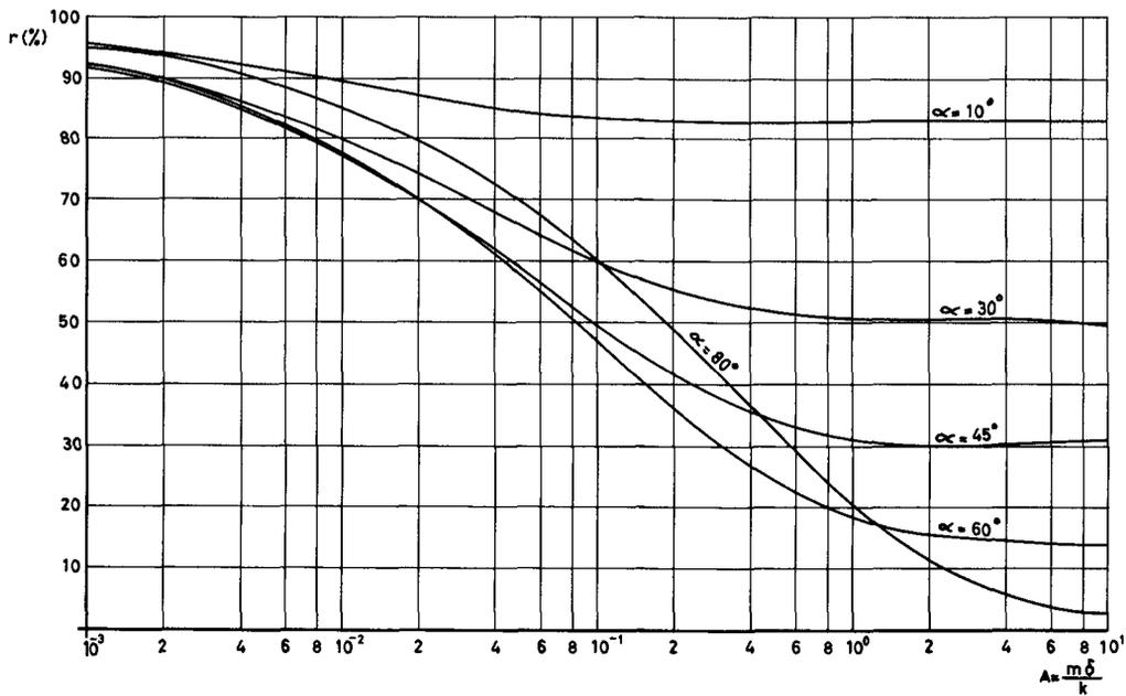
FIG 3 --PERCENTAGE OF ENERGY DISSIPATED BY BREAKING
