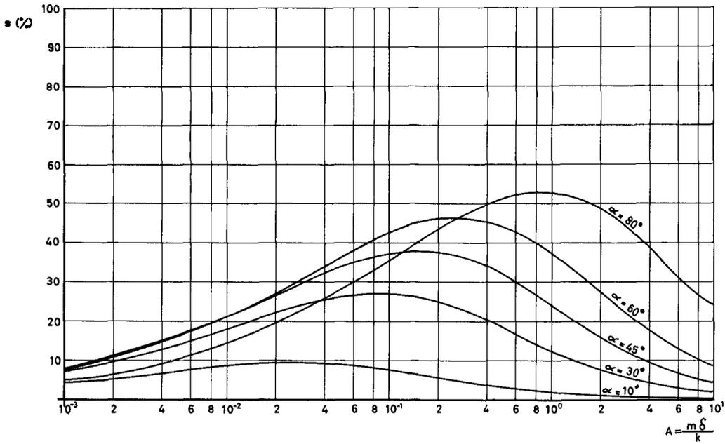
FIG 2 --PERCENTAGE OF ENERGY DISSIPATED BY FRICTION
